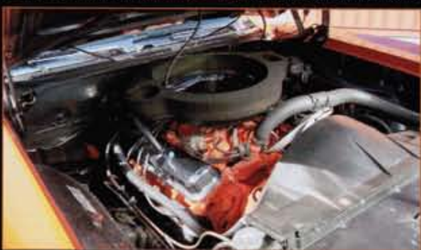
Original, aber grundlegend überholt: der 6,6 Liter große V8
