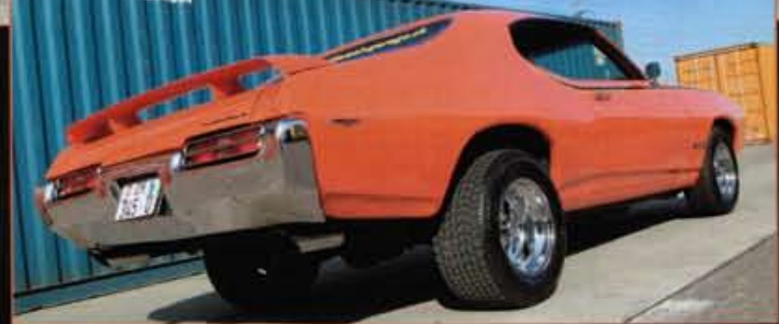
Hoch hinaus: Der Hinterachse verhalf Robert mittels Hi-Jacker-Stoßdämpfern von Gabriel in die Höhe
